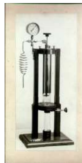
Appareil de condensation des gaz de démonstration, construit par Karol Olszewski, Cracovie 1884
