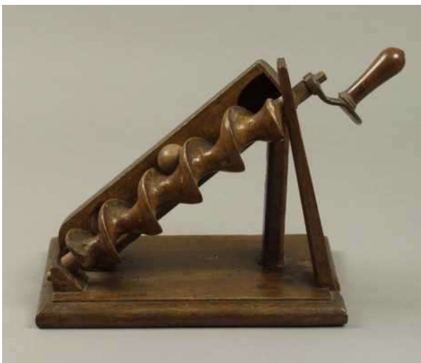
Vis d'Archimède, instrument didactique fabriqué à Cracovie pour les cabinets de physique, vers 1784, phot. Grzegorz Zygier
