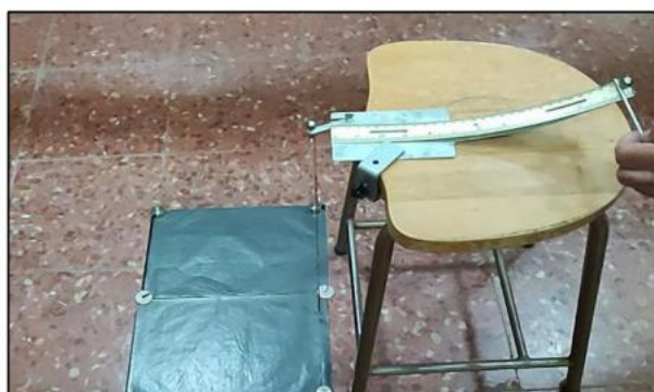
Fig. 17 Montaje del kit Collision in two dimensions, datos experimentales y cálculos. Fuente de la imagen: Antonio Pérez y José González.
