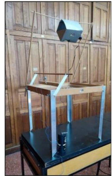
Fig. 13 Montaje de la cubeta de ondas. Fuente de la imagen: Autoría propia.
