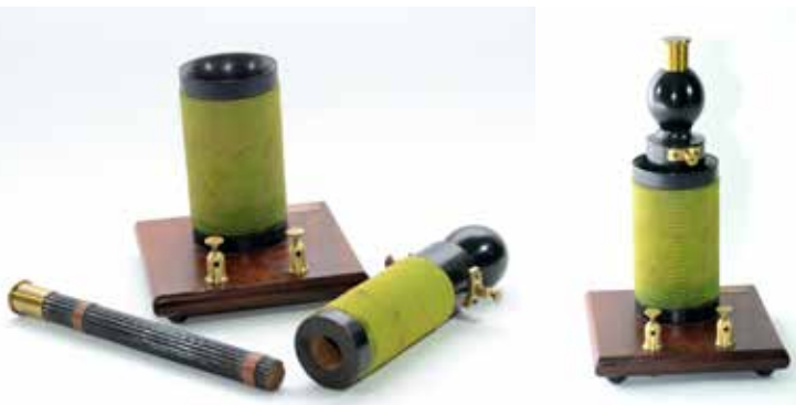
Fig. 5. Bobina doble de Faraday. Fecha de adquisición: 1880. Fabricante: Les Fils d'Emile Deyrolle.
