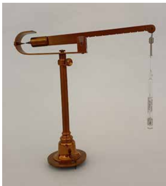
Fig 3. Balanza de Mohr-Westphal del IES "Pedro Espinosa".
