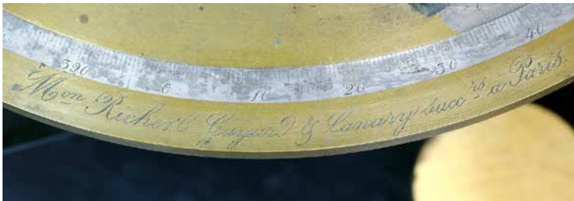
Fig. 5. Imagen tras una limpieza especialmente delicada. Se retiró el óxido que cubría la inscripción y la escala pero cuidando que el disolvente no eliminase la tinta de la misma.
