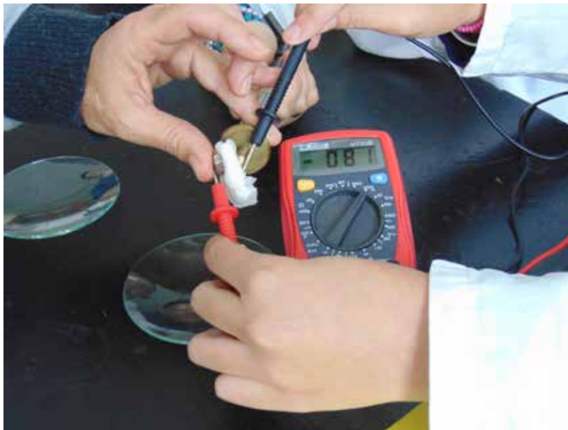
Fig. 10. La imagen muestra la tuerca actual de ferretería, pieza metálica gris, adquirida en sustitución de la original y que tiene que enroscar sobre el poste dorado. De la lectura del polímetro mostrada en la imagen se deduce que el poste original actúa de polo positivo y no sufriría corrosión por el contacto de la nueva tuerca.
