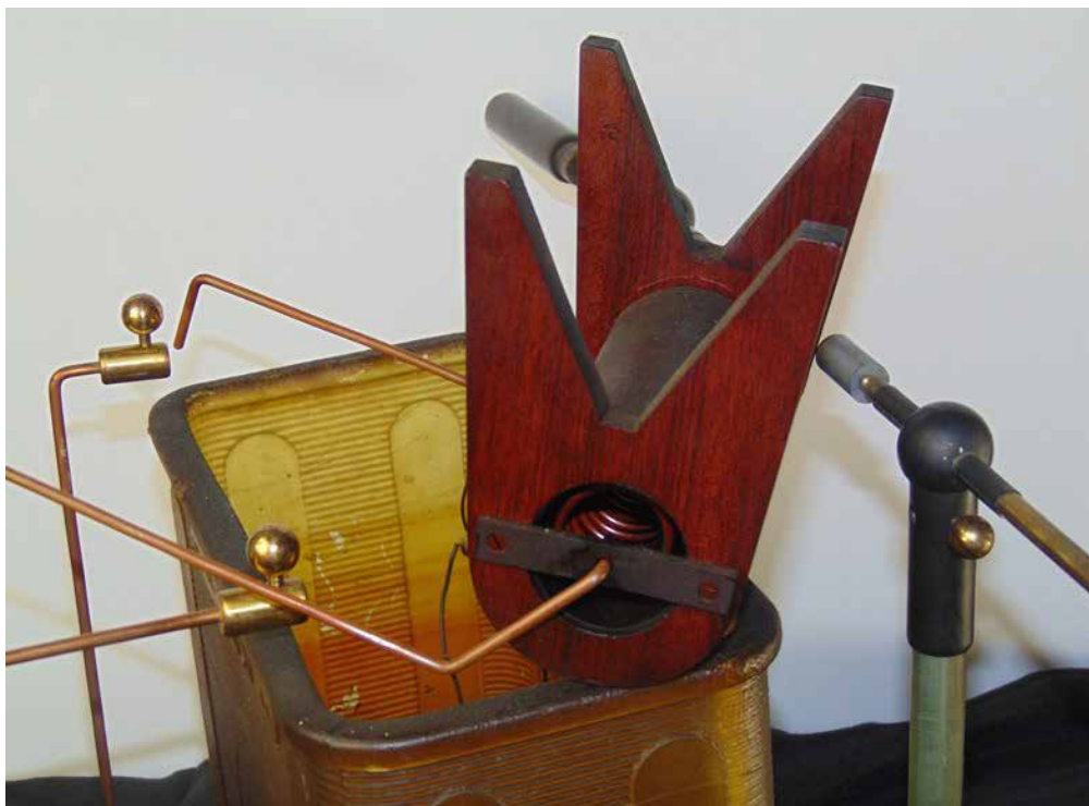
Fig. 6. Aparato Thomson y Tesla con el conjunto de las dos bobinas desmontadas para su limpieza y comprobación de su estado.
