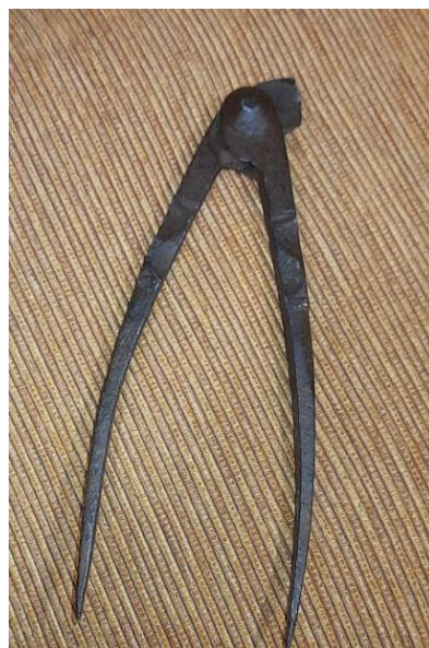
Figura 3. Compás de pautado con apéndice cortante, siglos XVII-XVIII. Instrumento de hierro forjado compuesto por doble punta y una cuchilla lateral extraíble. Colección Aula-Museo del IES Profesor Domínguez Ortiz
