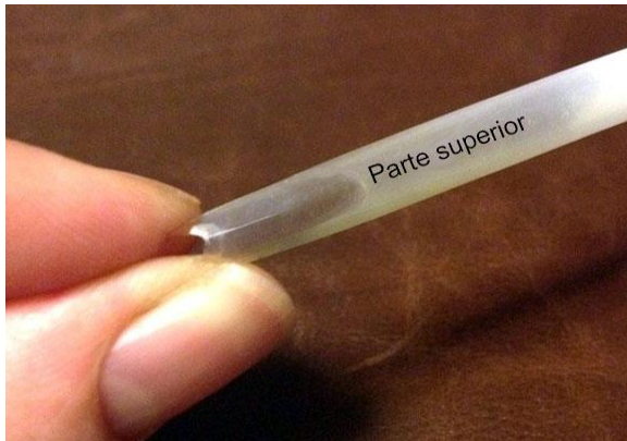
Figura 10. Formación de la hendidura longitudinal que regulará el flujo de tinta hacia el soporte
