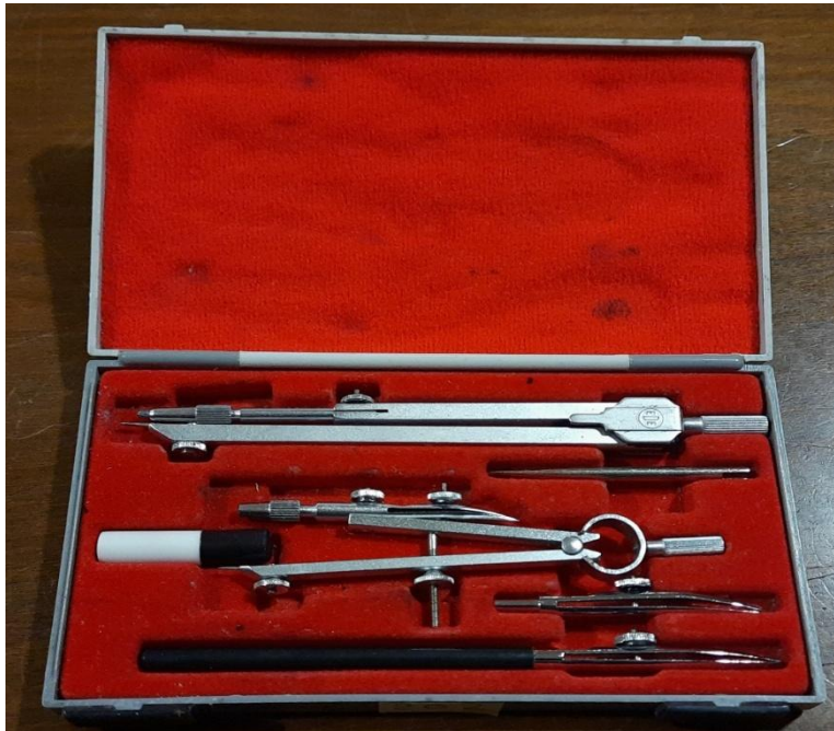
Figura 5. Juego de compás, bigotera y tiralíneas, década de 1970. Estuche escolar utilizado en la enseñanza del Dibujo Técnico. Incluye compás, tiralíneas, bigotera y accesorios para tinta líquida. Testimonio del mantenimiento de las técnicas tradicionales de entintado en la educación técnica del siglo XX. Colección Aula-Museo del IES Profesor Domínguez Ortiz
